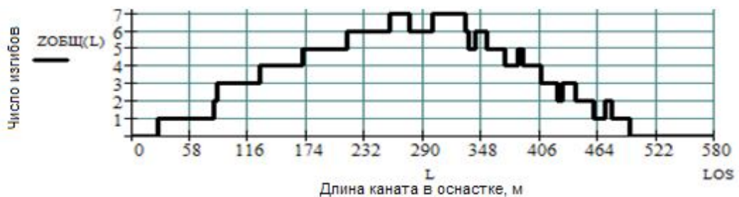
Рис. 5. Суммарное число изгибов каната в оснастке за один цикл работы каната
