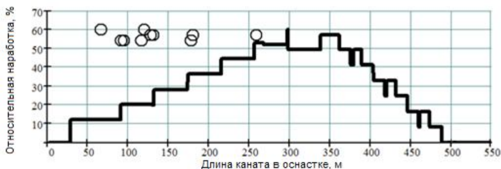
Рис. 12. Точки фактической отработки и предыдущая известная модель расходования ресурса каната
