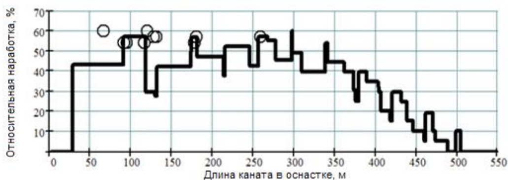
Рис. 11. Точки фактической отработки и разработанная модель расходования ресурса каната
