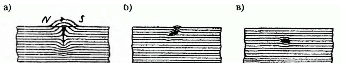
Рисунок 8 – Магнитное поле рассеяния над дефектом: а – поверхностным; б – подповерхностным; в – внутренним.
